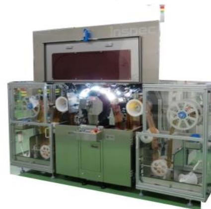
ロールtoロール型検査装置
