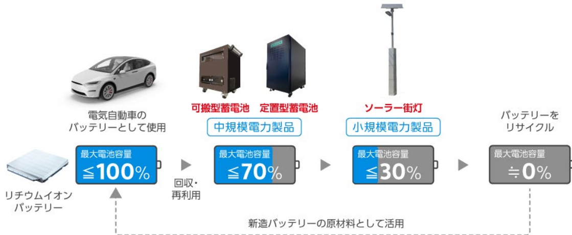
車載用リチウムイオンバッテリーにおけるサーキュラーエコノミーのイメージ
