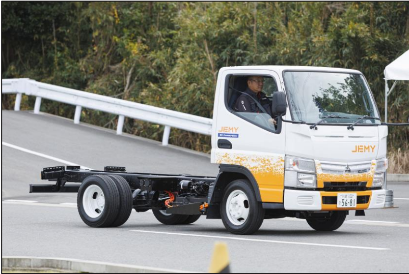
中古1.5トントラックEV改造 走行試験 (2024年11月)
