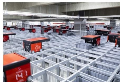
SBS リコーロジスティクスの「物流センター横浜金沢」では、自動倉庫システム「AutoStore（オートストア）」を ASEAN 地域圏大規模の規模で導入し生産性を高めている。
