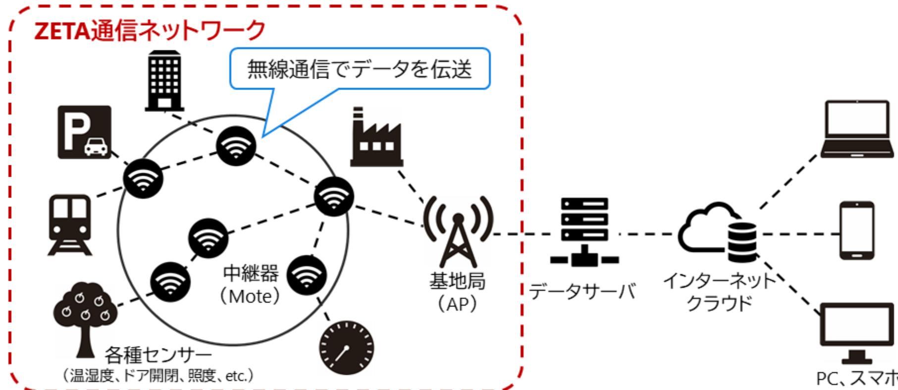
※ ZETA: ZiFiSense社が開発したLPWA(Low Power Wide Area)通信規格。超狭帯域(UNB: Ultra Narrow Band)による多チャンネルでの通信、マルチホップ・メッシュネットワークによる分散アクセス、双方向での低消費電力通信などの特長を持つ、IoTに適した最新のLPWAネットワーク規格。
